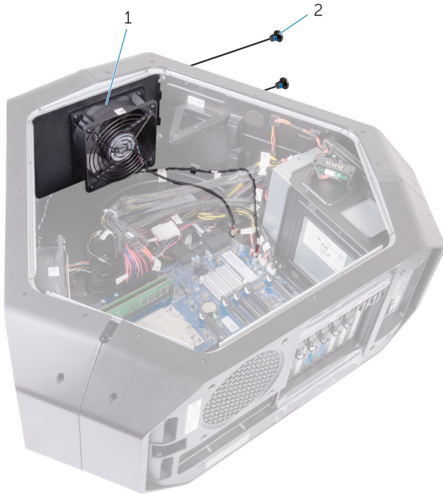
圖 41. 卸下 PCI 風扇
